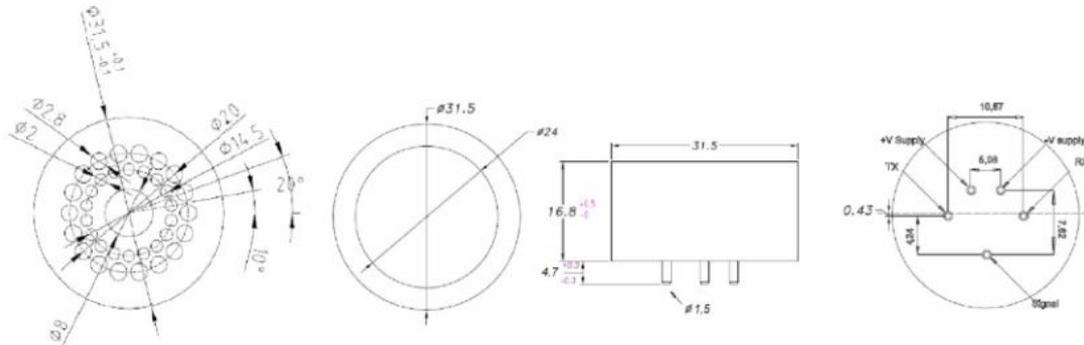
上图所有数据单位均为毫米。无 TX 和 RX 引脚的 3 引脚版本（用于 Modbus 通讯协议）可按需定制。
